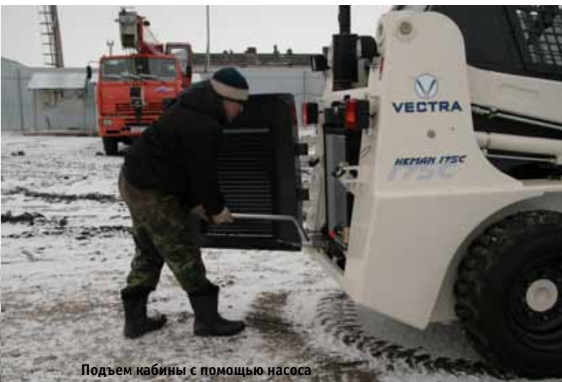
Подъем кабины с помощью насоса
